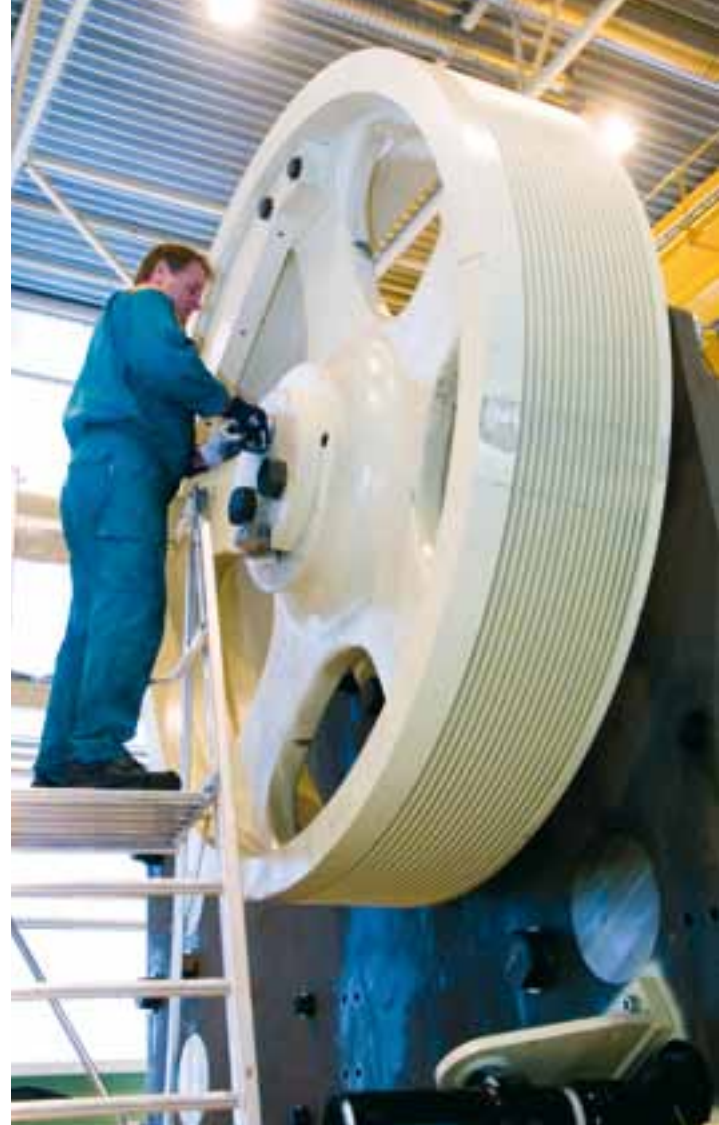
Leukamurskaimeen asennetaan vauhtipyörää Metson Tampereen tehtaalla. KUVA: METSO
