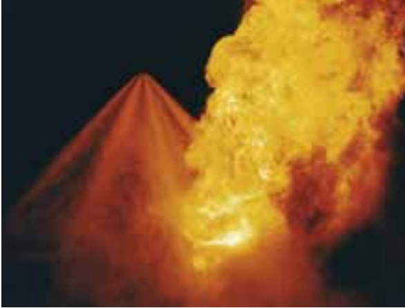
Göran Sundholmın kehittämä suutin hajottaa veden hyvin hienojakoiseksi sumuksi, joka sammuttaa myös öljypalot. Se ei normaalisti vedellä onnistu. KUVA: MARIOFF
