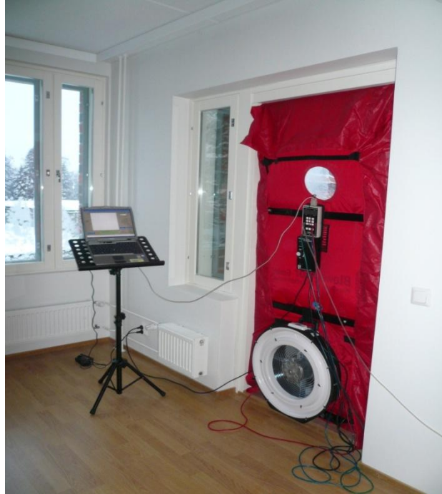
Kuva 6. Tiiviysmittauslaitteisto (kuva ei ole kohteesta).
